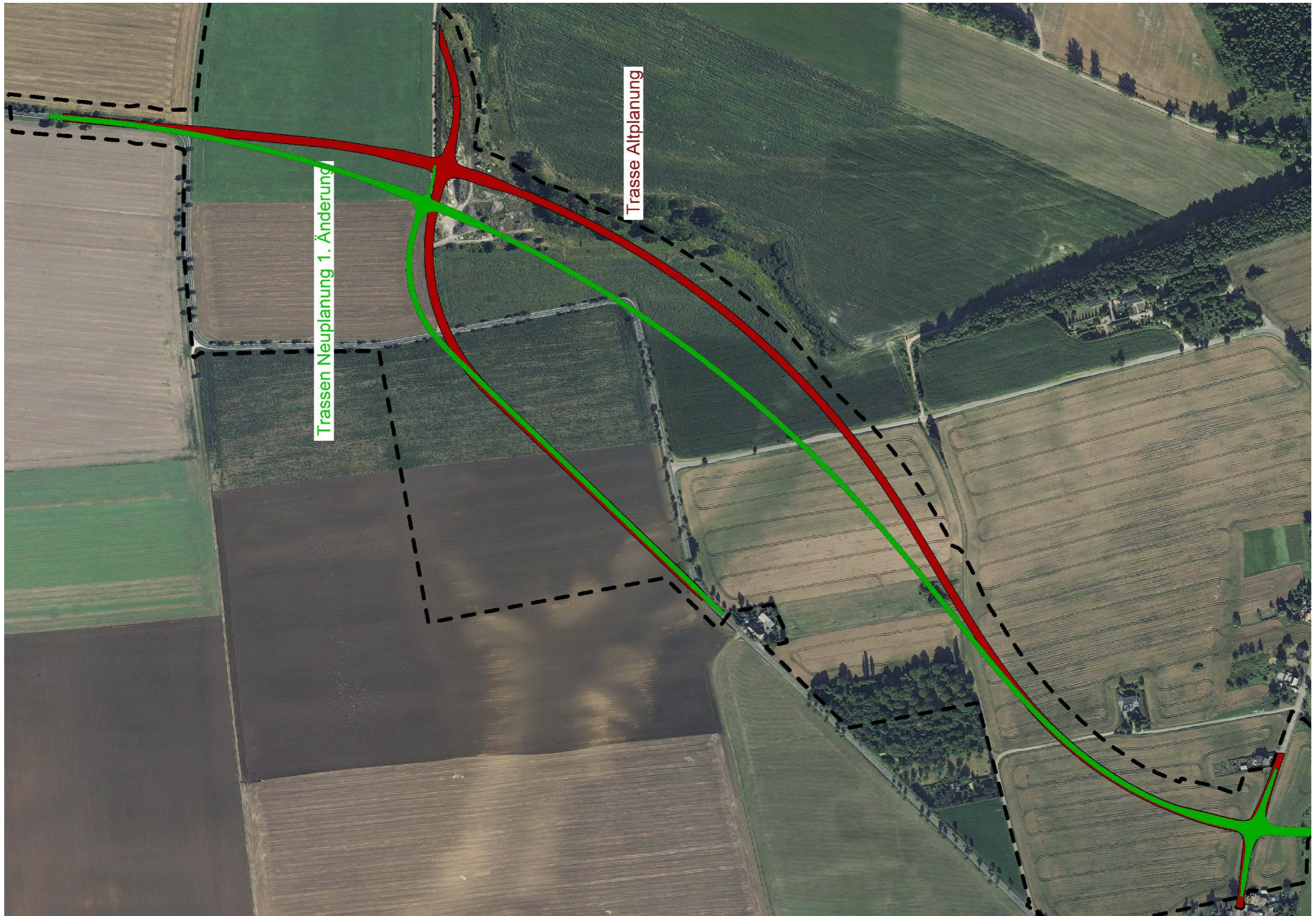
Abbildung 1 Alter und Neuer Trassenverlauf
